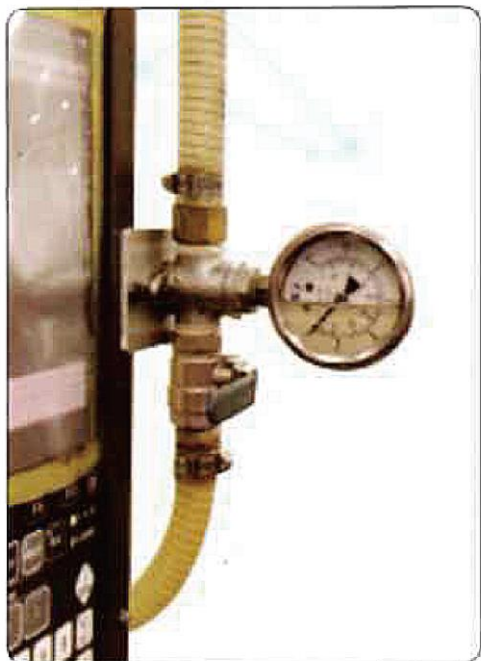
手動閥開關與真空錶在機台上安裝示意
